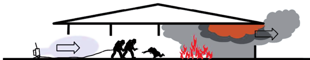
Figura 1. En un APP se desaloja el humo y se introduce una atmósfera limpia que permite una progresión rápida de los bomberos dentro de la estructura. Las condiciones de seguridad para bomberos y las de supervivencia para la víctima mejoran desde el momento que se inicia la ventilación
