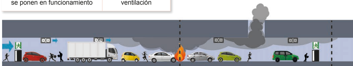
Imagen 3. Túnel de ventilación longitudinal con extracción masiva de humo
