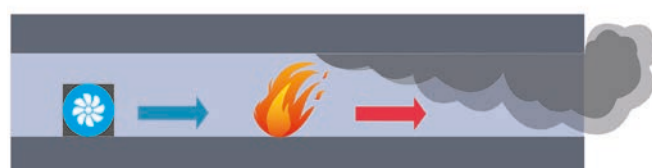
Imagen 15. Desplazamiento de gases dentro del túnel con ventilador
