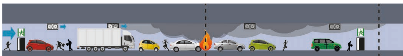
Imagen 2. Túnel de ventilación longitudinal
