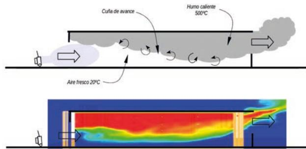
**Imagen 125.** Esquema de modelización en FDS (Fire Dynamic Simulator) de una Ventilación VPP Ofensiva donde la diferencia de presiones evita que el aire fresco y los gases de incendio se mezclen excesivamente
