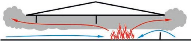
**Imagen 110.** Ventilación natural horizontal con claro flujo bidireccional
