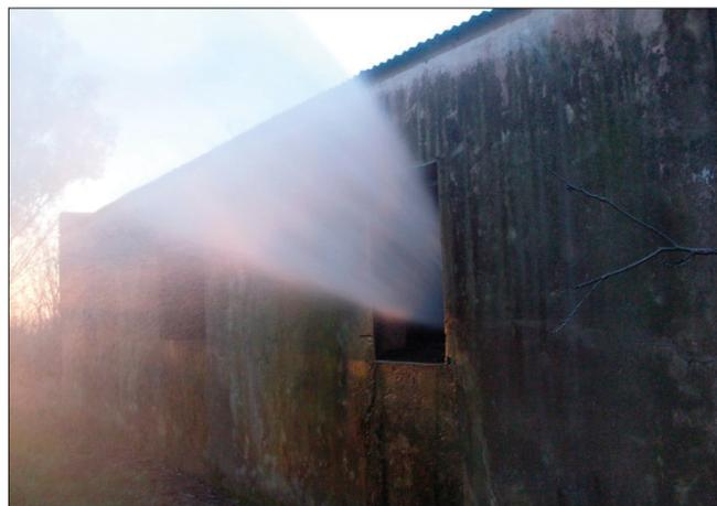
Imagen 118. Ventilación hidráulica
