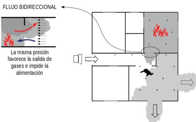
**Imagen 121.** Ventilación VPP defensiva sin el confinamiento del recinto de incendio. El flujo bidireccional se mantiene tras el inicio de la ventilación. Tan pronto sea posible deberá confinarse el incendio
