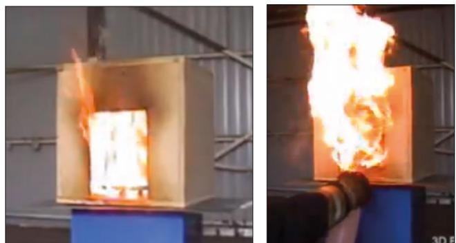
Imagen 74. Clásico ejercicio en "casa de muñecas". La aplicación del spray de agua al interior desplaza los gases de incendio al exterior que se inflaman al contacto con el aire
