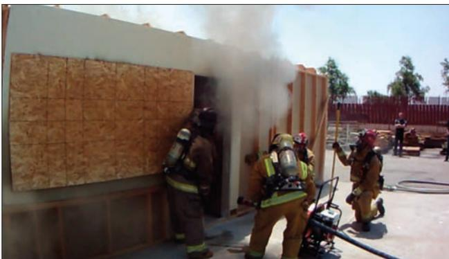
**Imagen 136.** Bomberos observando el funcionamiento del barómetro en la entrada al inicio de una operación con empleo de Ventilación VPP Ofensiva
