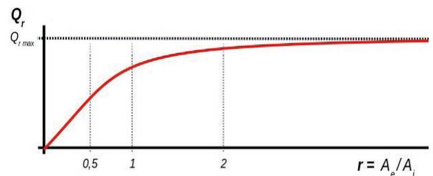
Imagen 142. Variación del caudal efectivo ( $Q_r$ ) y la relación ( $r$ ) entre la salida de gases ( $A_e$ ) y la entrada ( $A_i$ ). Una salida dos veces el tamaño de la salida da resultados más que suficientes
