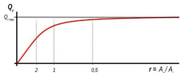
Imagen 109. Variación del caudal efectivo ( $Q_r$ ) y la relación ( $r$ ) entre la salida de gases ( $A_e$ ) y la entrada ( $A_i$ ). Una entrada dos veces el tamaño de la salida da resultados más que suficientes
