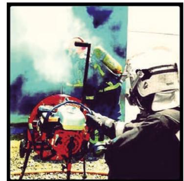
**Imagen 3.** Bomberos aplicando técnicas de ventilación ofensiva para mejorar rápidamente las condiciones de visibilidad
