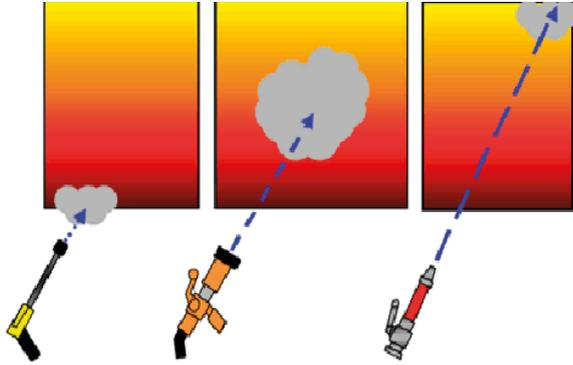
**Imagen 46.** Efecto del tamaño de gota en la penetración dentro de los gases de incendio. Un tamaño de gota excesivamente pequeño produce la evaporación en las inmediaciones del bombero, exponiéndolo al vapor de agua. Un chorro sólido por su parte penetra evaporándose mínimamente hasta impactar con el entorno
