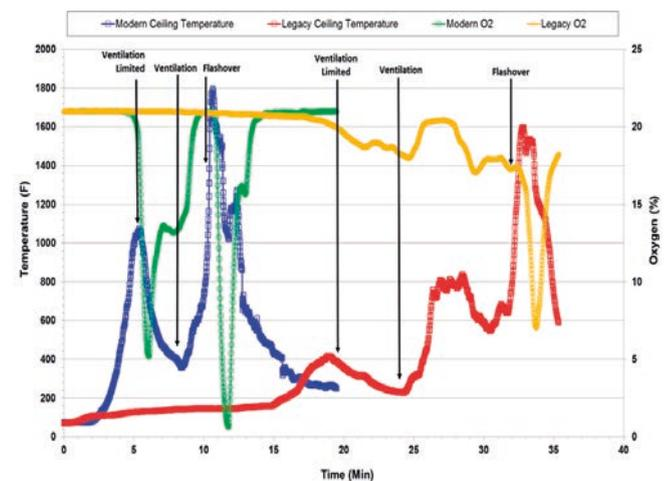
**Imagen 34.** Evolución de la temperatura y las concentración de oxígeno en el experimento de Underwriters Laboratories comparando la evolución de un incendio con combustible moderno y otro con tradicional en una misma vivienda reproducida a escala real
