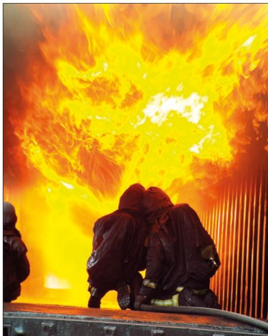
**Imagen 25.** Inflamación generalizada en una cámara de entrenamiento a base de GLP
