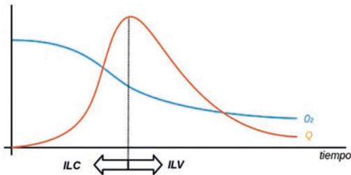
**Imagen 60.** Evolución de la concentración de oxígeno y la potencia de incendio a lo largo del desarrollo de un incendio. Claramente puede apreciarse como la caída de la potencia del incendio está vinculada al déficit de oxígeno
